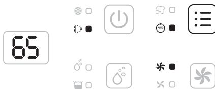
Premere una seconda volta il pulsante di modalità per selezionare la modalità automatica. L'unità funziona automaticamente in base all'umidità relativa misurata (RF%), come indicato nella tabella seguente:
