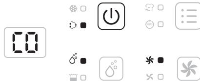
Branchez l'appareil sur le réseau électrique et appuyez une fois sur le bouton Power pour mettre l'appareil en marche. Par défaut, l'appareil fonctionne en mode manuel continu avec une vitesse de ventilation élevée et le voyant marche/arrêt s'allume.
