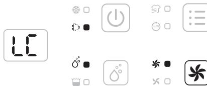
Drücken Sie die Lüftergeschwindigkeitstaste für 2 Sekunden, um alle Tasten mit einem hörbaren Piepen zu sperren. Auf dieselbe Weise kann die Sperre wieder aufgehoben werden.
