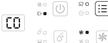
Drücken Sie die Modus-Taste einmal, um den Wäschetrocknungsmodus auszuwählen. Das Gerät läuft dann 6 Stunden lang in kontinuierlicher Entfeuchtung mit hoher Gebläsedrehzahl, danach schaltet es sich automatisch aus.
