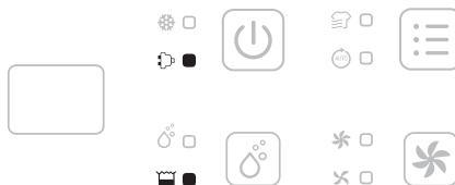
Si le réservoir d'eau est plein ou mal installé, l'appareil passe en mode veille. Après avoir vidé le réservoir d'eau ou l'avoir correctement installé, l'appareil revient au mode précédemment réglé. À l'exception de la touche marche / arrêt, toutes les autres touches sont inutilisables.
