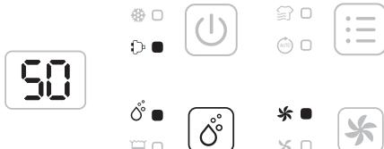
Drücken Sie die Manuell-Taste, um Ihre bevorzugte Luftfeuchtigkeit zwischen CO-30%-35%-40%-45%-50%-55%-60%-65%-70%-75%-80%-CO auszuwählen. CO bedeutet kontinuierliche Entfeuchtung unabhängig von der Umgebungsfeuchtigkeit.
