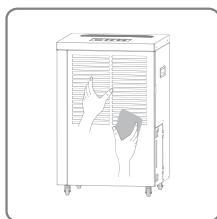
2. Reinigen Sie das Gehäuse mit einem weichen, trockenen Tuch. Bei starker Verschmutzung verwenden Sie ein mildes Reinigungsmittel. Wischen Sie den Luftentfeuchter mit einem leicht feuchten Tuch ab. Spritzen Sie das Gerät niemals mit Wasser ab.
