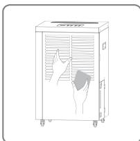
2. Nettoyez le boîtier avec un chiffon doux et sec. Si l'appareil est très sale, utilisez un produit de nettoyage doux. Essuyez le déshumidificateur avec un chiffon légèrement humide. Ne jamais asperger l'appareil avec de l'eau.
