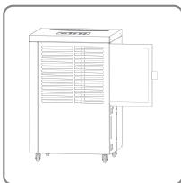
3. Rimuovere il filtro, pulirlo con un aspirapolvere o con acqua saponata non più calda di 40 °C.
