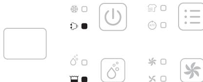
Se il serbatoio dell'acqua è pieno o non è installato correttamente, la macchina passa in modalità standby. Dopo aver svuotato o installato correttamente il serbatoio dell'acqua, la macchina passa alla modalità precedentemente impostata. Ad eccezione del pulsante On / Off, tutti gli altri pulsanti non sono utilizzabili.
