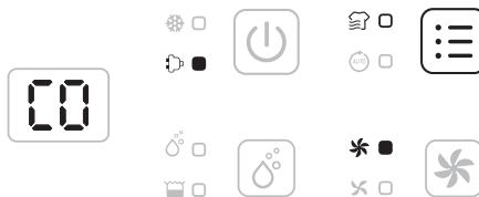
Premere una volta il pulsante di modalità per selezionare la modalità di asciugatura del bucato. L'apparecchio funziona quindi in deumidificazione continua ad alta velocità della ventola per 6 ore, dopodiché si spegne automaticamente.
