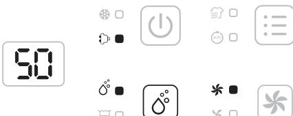
Appuyez sur le bouton Manuel pour sélectionner votre taux d'humidité préféré entre CO-30%-35%-40%-45%-50%-55%-60%-65%-70%-75%-80%-CO. CO signifie déshumidification continue, indépendamment de l'humidité ambiante.
