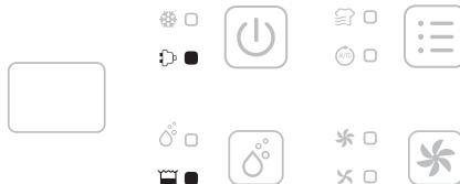
Wenn der Wassertank voll oder nicht richtig installiert ist, wechselt das Gerät in den Standby-Modus. Nach dem Entleeren oder dem ordnungsgemäßen Einsetzen des Wassertanks wechselt das Gerät in den zuvor eingestellten Modus. Mit Ausnahme der Ein- / Aus-Taste sind alle anderen Tasten nicht bedienbar.
