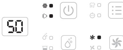
Se nell'unità si forma del ghiaccio a bassa temperatura ambiente, il deumidificatore passa alla modalità di sbrinamento. L'unità funziona ad alta velocità del ventilatore senza deumidificare. Non appena il ghiaccio si è scongelato, l'unità riprende automaticamente il funzionamento di deumidificazione.
