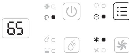
Appuyez une deuxième fois sur le bouton Mode pour sélectionner le mode automatique. L'appareil fonctionne automatiquement en fonction de l'humidité relative (RF%) mesurée, comme indiqué dans le tableau ci-dessous :
