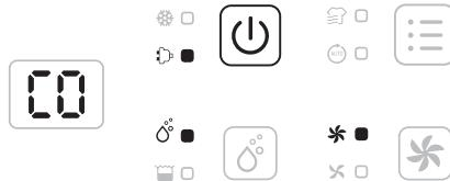
Schliessen Sie das Gerät an das Stromnetz an und drücken Sie die Power-Taste einmal, um das Gerät einzuschalten. Das Gerät läuft standardmässig im manuellen Dauerbetrieb mit hoher Ventilatordrehzahl, und die Ein- / Aus-Anzeige leuchtet. Drücken Sie die Power-Taste erneut, um das Gerät auszuschalten. Der Ventilator wird einige Sekunden lang weiterlaufen, um die im Gerät verbliebene heisse Luft herauszublasen.
