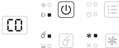
Collegare l'unità alla rete elettrica e premere una volta il pulsante di accensione per accenderla. Per impostazione predefinita, l'unità funziona in modalità manuale continua ad alta velocità del ventilatore e l'indicatore di accensione/spegnimento si accende.
