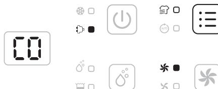
Appuyez une fois sur le bouton Mode pour sélectionner le mode Séchage du linge. L'appareil fonctionne alors en déshumidification continue pendant 6 heures avec une vitesse de soufflerie élevée, puis il s'arrête automatiquement.
