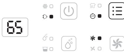
Drücken Sie die Modus-Taste ein zweites Mal, um den Automatikmodus zu wählen. Das Gerät arbeitet automatisch entsprechend der gemessenen relativen Luftfeuchtigkeit (RF%), wie in der Tabelle unten dargestellt:
